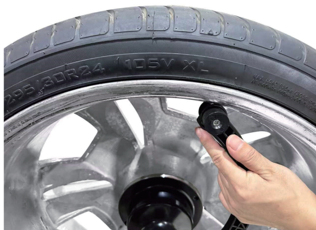
ALU-S-Auswuchtmodus (Auswuchtgewichtinstallation mit dem automatischen Messarm)
