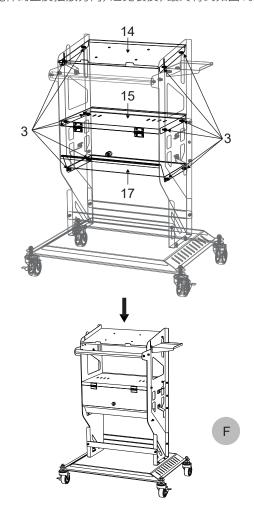
**安装步骤7** ● 找出图中序号配件,将19用螺丝锁在已经装配好的 F 上,注意配 件的正反摆放方向,避免装反,最终得到如图 G。
